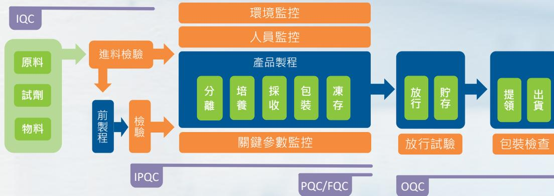
依製程產品生產流程，產品品質管控點的有：IQC原物料檢測、IPQC製程品質管控、PQC半成品檢驗、FQC最終產品檢驗，以及OQC出貨檢驗等。所有的品管點檢驗，包含放行試驗與包裝檢查，都要經過三顧品質部門，即品質管制單位及品質保證單位作業及審核，確保優質的生醫產品。
